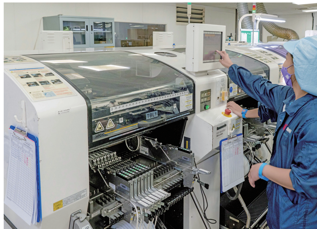
▲ 工廠內的快速打件機極具效能，當客戶只有軟體能力，邁特能滿足韌體與硬體的需求。
