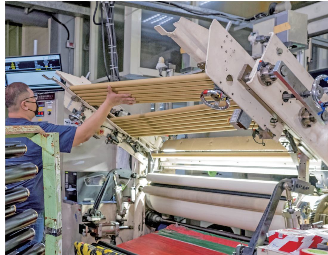
▲ 透過產線上方安裝的AI檢測器，可以即時判斷每捲膠帶成品品質，並透過螢幕檢視，取代以往用人工檢查的困擾。
