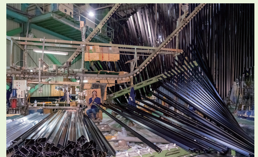
► 皇鎰擁有四條產線，兩條陽極處理、兩條粉體塗裝，每月處理的鋁材多達2000噸。
